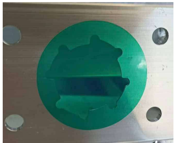
Bild 5: Positioniergenauigkeit bei Abklebemaßen in der Fläche, die nicht an Kanten angelegt werden können.
