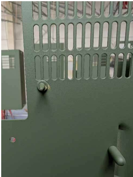
Bild 3: Spritzschatten, Beispiel aus Nasslackbereich
